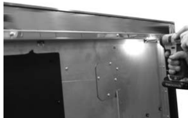
Fig. 79 - Retrait des vis
