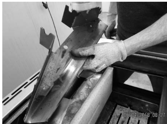
Fig. 69 - Retirer le profil
