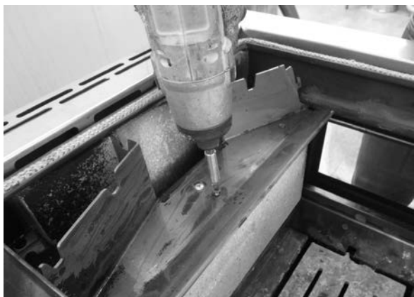
Fig. 68 - Retirer les vis
