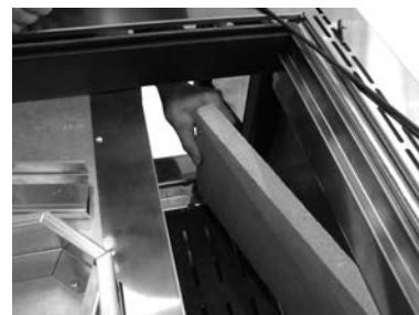
Fig. 72 - Retirer le matériau réfractaire
