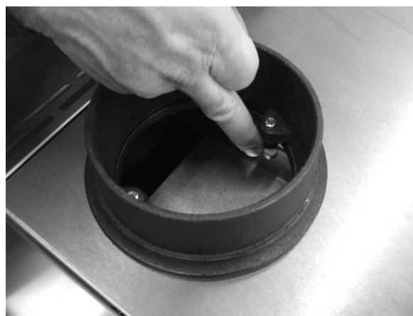
Fig. 51 - Fixer le tuyau
