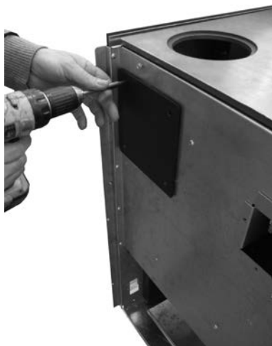
Fig. 52 - Retrait du bouchon
