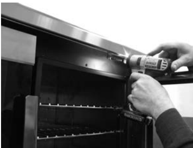
Fig. 78 - Retrait des vis
