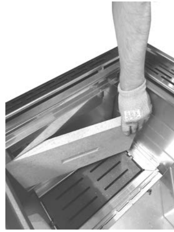
Fig. 77 - Retirer le profil
