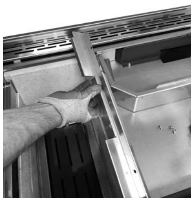
Fig. 74 - Retirer le profil
