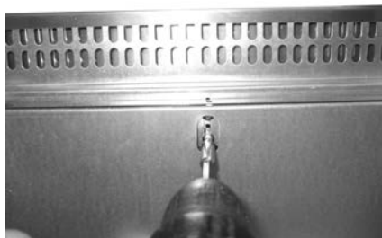
Fig. 19 - Ôter/desserrer les vis
