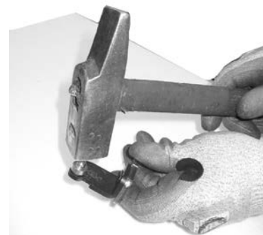
Fig. 24 - Insérer le goujon au contraire
